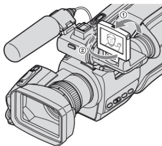
Ouvrez le panneau LCD à 90 degrés par rapport au caméscope (①), puis faites-le pivoter de 180 degrés pour le diriger du même côté que l'objectif (②).
