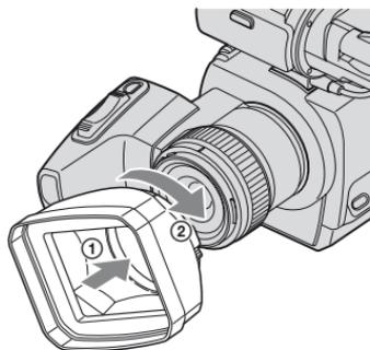
Alignez les repères du capot de l'objectif sur ceux du caméscope, puis faites pivoter le capot de l'objectif dans le sens de la flèche.
