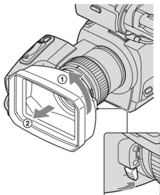
Faites pivoter le capot de l'objectif dans le sens opposé à la flèche, comme illustré ci-dessus, en maintenant enfoncé le levier situé sur le couvercle du capot de l'objectif.
